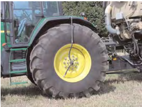
Abbildung 9: Reifendruckregelanlagen erlauben eine Anpassung des Reifennendrucks vom Schleppersitz aus. Die Luft wird über außenliegende Leitungen (links) oder durch die Radnabe zu den Reifen geleitet.
