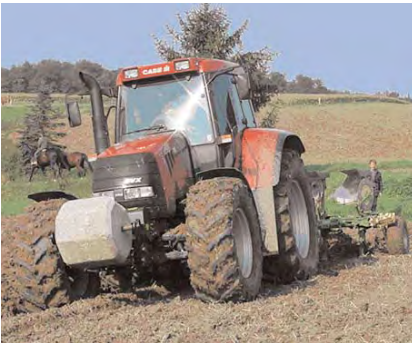
Abbildung 10: Zusatzgewichte müssen sich schnell und bequem an- und abbauen lassen. Frontpacker nutzen das Gewicht zur zusätzlichen Bodenbearbeitung.
