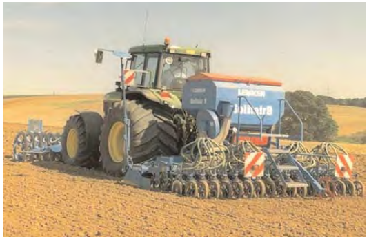
Abbildung 10: Zusatzgewichte müssen sich schnell und bequem an- und abbauen lassen. Frontpacker nutzen das Gewicht zur zusätzlichen Bodenbearbeitung.
