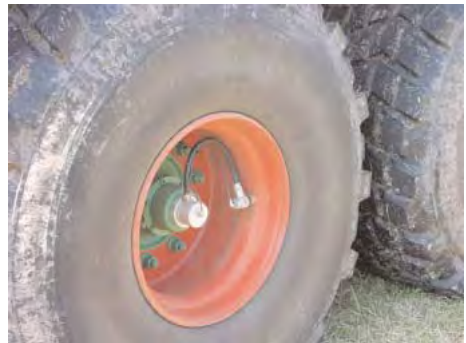
Abbildung 9: Reifendruckregelanlagen erlauben eine Anpassung des Reifennendrucks vom Schleppersitz aus. Die Luft wird über außenliegende Leitungen (links) oder durch die Radnabe zu den Reifen geleitet.
