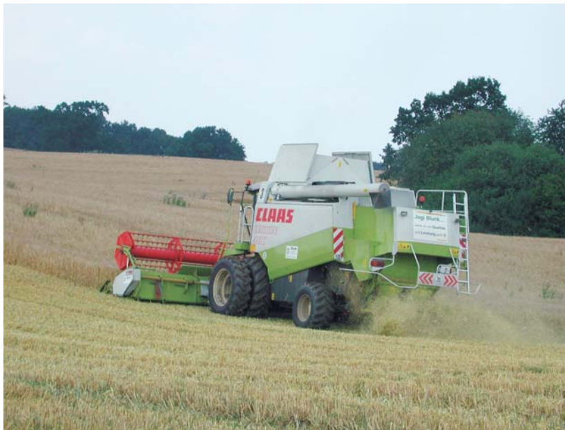
Abb. 10: Mähdrescher mit Zwillingbereifung
