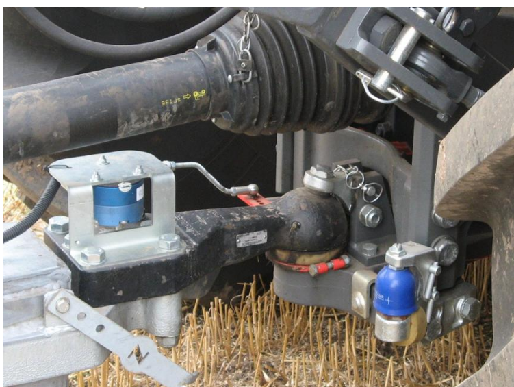
Abbildung 9b: Kugelkopfkupplung 80 an einem Standardtraktor (Foto: Fröba)
