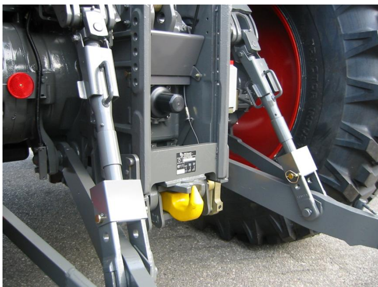
Abbildung 7a: Hitchanhängerkupplung an einem Standardtraktor (Foto: AGCO-Fendt)
