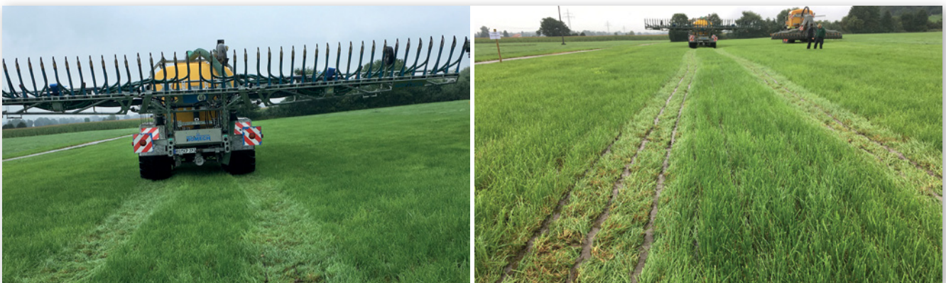
Abbildung 9: Ist der Grasbestand schon höher gewachsen und der Boden nass, ist auch bei Schleppschuhtechnik Vorsicht geboten. Nicht zwangsläufig treten Probleme in Fahrspuren auf (Bild links). Kommt es jedoch zu einem Niederwalzen des Bestands in der Fahrspur, durchdringt der Schuh nicht die Grasnarbe (Bild rechts). Ist zudem die Güllemenge noch zu hoch, sind Verschmutzungsprobleme vorprogrammiert. (Quelle: LfL)
