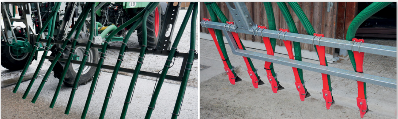
Abbildung 2: Unterschied zwischen Schleppschlauchtechnik (links) und Schleppschuhtechnik (rechts), hier dargestellt für die Gülleausbringung im Versuchswesen. Schleppschuhe wurden insbesondere für die Ausbringung auf Grünland entwickelt. (Quelle: BaySG)
