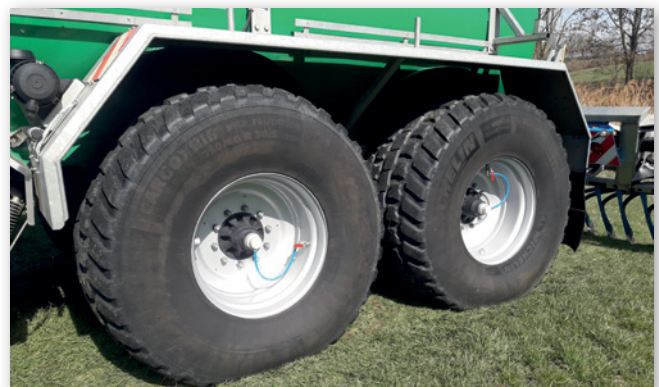
Abbildung 12: Um Schadverdichtungen des Bodens und mögliche Verschmutzungen des Futters zu reduzieren bzw. zu vermeiden, sollte der Reifeninnendruck bei Fahrten auf dem Feld maximal 0,8 bar betragen. Reifendruckregelanlagen ermöglichen die schnelle und komfortable Anpassung des Reifeninnendrucks. (Quelle: LAZBW Aulendorf)
