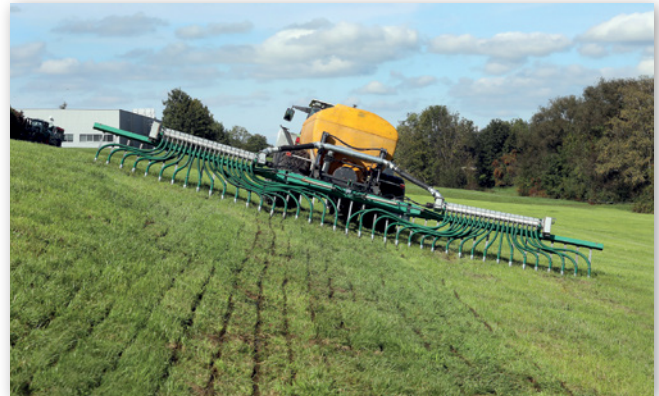
Abbildung 13: Gerade in Hanglagen werden erhöhte Anforderungen an die Technik gestellt, um die Gülle sauber an den Boden zu bekommen. (Quelle: LfL)
