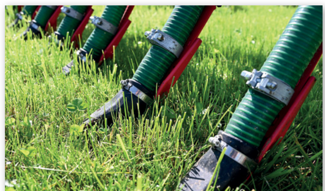
Abbildung 3: Ziel beim Schleppschuh: Scheiteln des Pflanzenbestands und Ablage des flüssigen Wirtschaftsdüngers auf den Boden bzw. in den durch die Kufen leicht angeritzten Boden. (Quelle: LfL)
