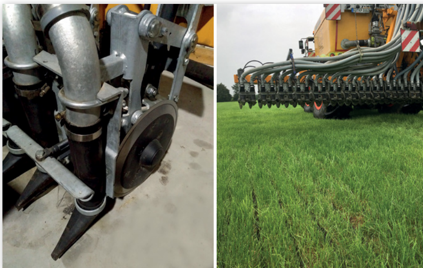
Abbildung 4: Bei der Gülleinjektion werden mit einer Schneidscheibe Grasnarbe und Boden aufgeschnitten und nachfolgend die Gülle in den entstandenen Schlitz abgelegt. Das linke Bild zeigt das Prinzip der Technik, das rechte Bild das Ergebnis im Bestand. (Quelle: LfL)
