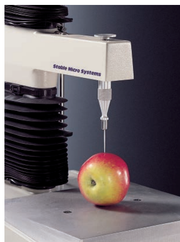
Abb. 6: Reifemessung bei Früchten
