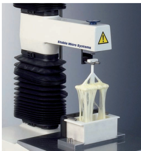
Abb. 5: Dehnbarkeitsmessung bei Pizzakäse
