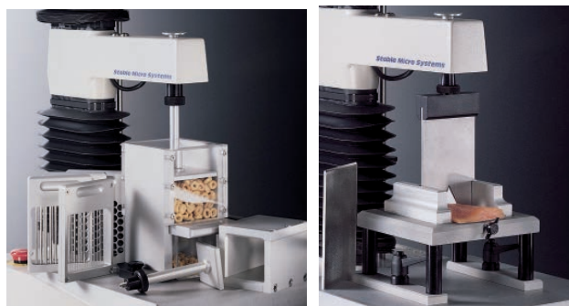
Abb. 3: Bissfestigkeitstests mittels Warner-Bratzler Scherzelle und Ottawa Zelle
