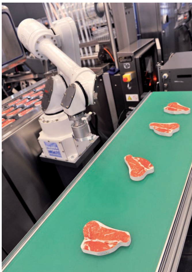
Abb. 8: Knickarmroboter beim Einsatz in der Fleischverpackung
