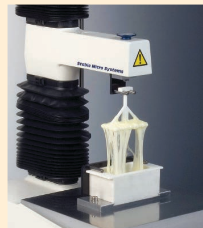
Dehnbarkeitsmessung bei Pizzakäse
