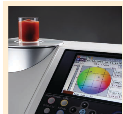
Kombiniertes spektrales Farbmessgerät (Spektralphotometer) mit Reflektions- und Transmissions-Messgeometrie CM 5 (Konica Minolta)
