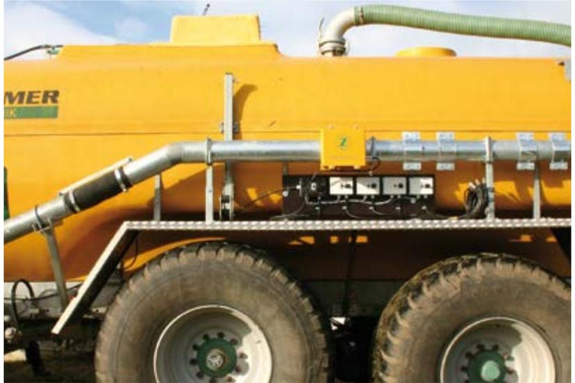
DLG-Messaufbau mit NIR-Sensor am Güllefass
